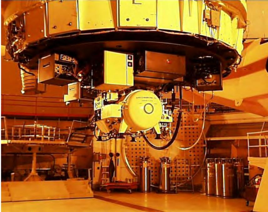
Spectromètre par transformée de Fourier du télescope Canada-France-Hawaï (CFHT)
